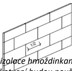
Schéma provedení vazby při pokládce desek tepelné izolace
